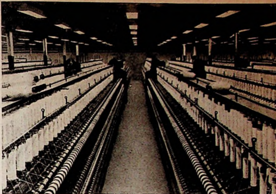
Spinnerij verlicht met één buislamp TL-40 W per reflector. Sterkte 180 lux.
